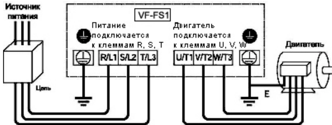
Подключение к источнику питания и двигателю
